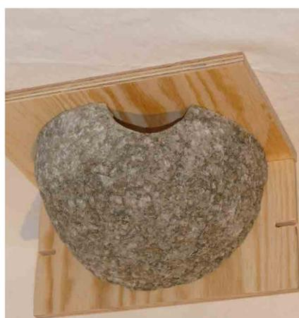
Im Rahmen des Grand Prix der Biodiversität konnte in vielen Testläufen eine Rezeptur für das künstliche Nestmaterial – eine spezielle Mischung aus Holzspänen und Zement – entwickelt und eine Form entworfen werden. Einstweilen werden 20 Formen in einem 3-D-Drucker gedruckt, weitere sind in Arbeit. Über 300 Stück wurden bereits an Organisationen und Privatpersonen geliefert.
