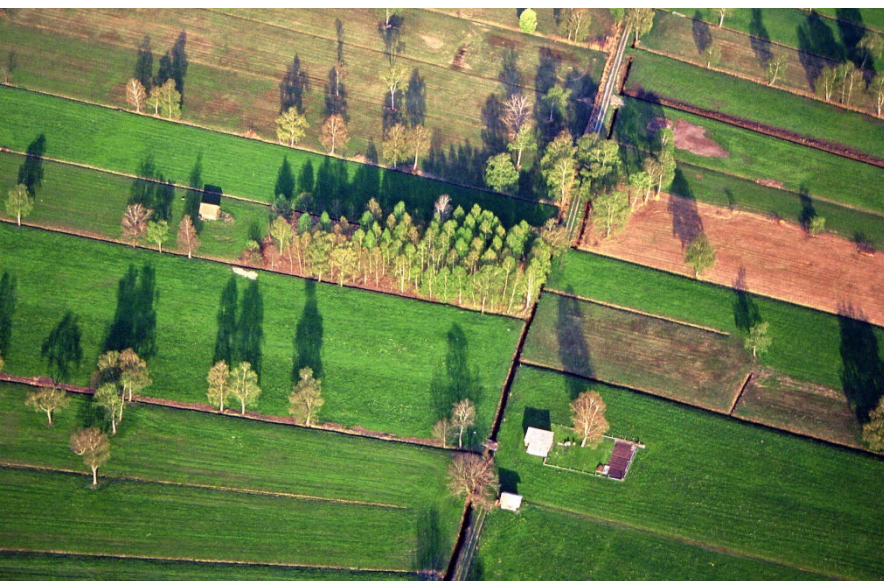
Entwässerungsgräben trocknen die Riedgebiete aus und gefährden nicht nur die typischen Riedarten. Aus den entwässerten Niedermoorböden entweicht zudem klimaschädliches CO 2 © Reinhard Büchele
