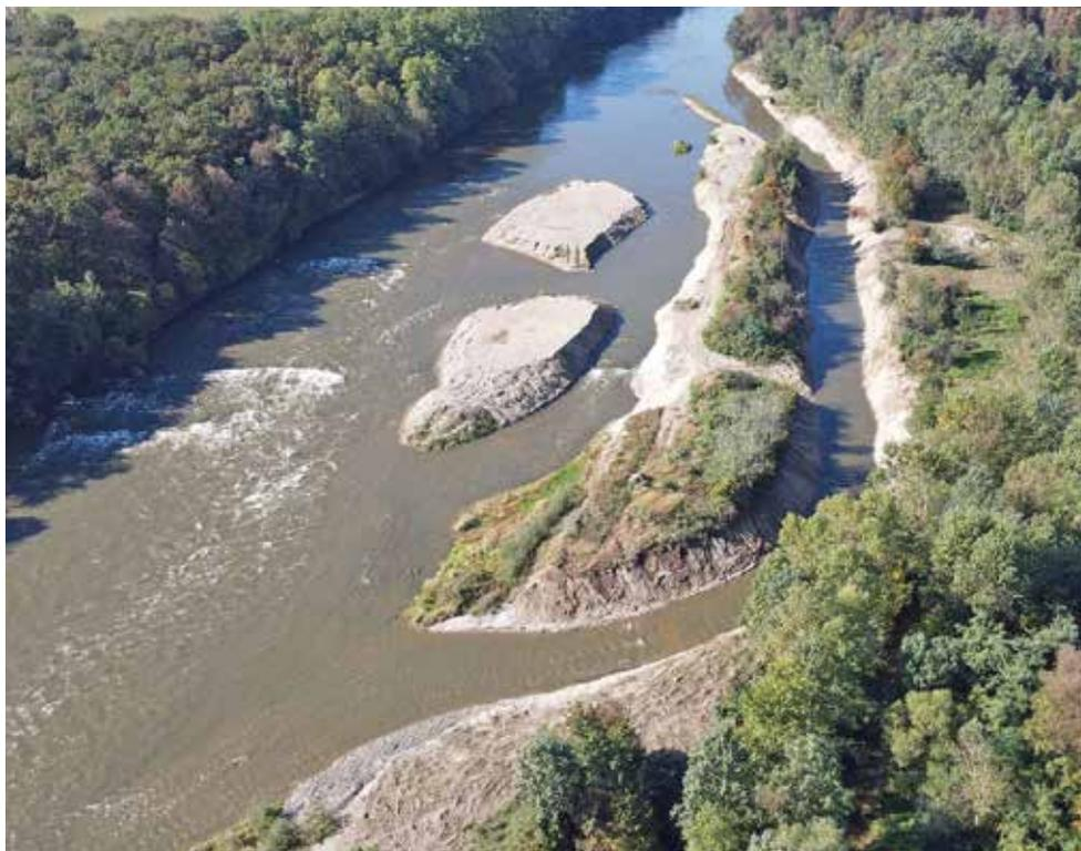
Fertiggestellter neuer Seitenarm der Mur mit vorgelagerten strömungslenkenden Schotterinseln und Steilufern.
