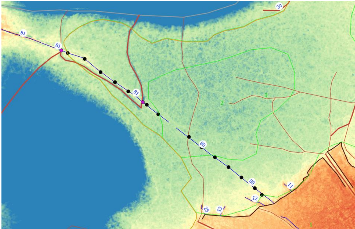
Abbildung 24: Höhenmodell des intakten Torfkörpers nördlich der Torfstickkante im Moorwald Gebharts Nord. (Höhengradient entlang des Farbverlaufes in 0,5 m - Schritten von rot (547 m) bis blau (549 m). Legende siehe Abbildung 23
