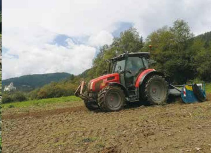
Oberflächliche Bodenbearbeitung mit Spatenmaschine
